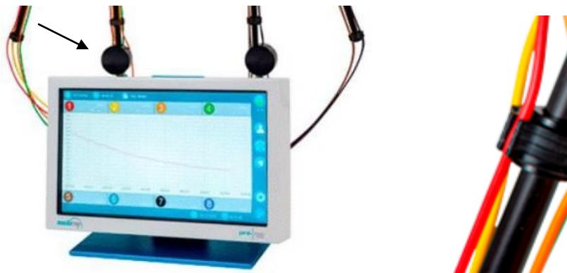
Sensorkabel sorgfältig in die Führungsclips einlegen.
