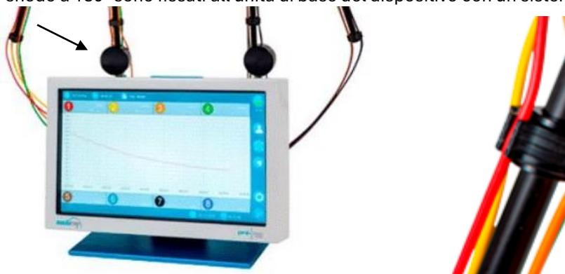
Inserire con cautela il cavo del sensore nelle clip di guida.
