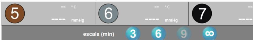
Seleccionando el escalado entre 3, 6 o 9 minutos, se pueden mostrar en la pantalla los últimos minutos del gráfico de medición de una medición en vivo.
