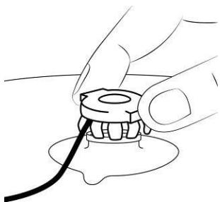
La testa del sensore può essere inserita nell'anello di fissaggio con un sistema a scatto. Per evitare che il sensore si stacchi, assicurarsi che il cavo non sia in tensione durante l'inserimento.
