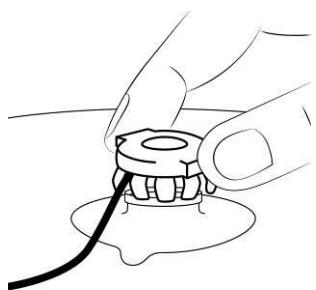
Der Sensorkopf lässt sich mittels eines One-Touch Klicksystems in den Fixierring einsetzen. Um ein Abscheren des Sensors zu vermeiden, muss beim Einsetzen beachtet werden, dass kein Zug am Kabel entsteht.
