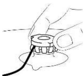
El cabezal del sensor se puede insertar en el anillo de fijación mediante un sistema de clic de un solo toque. Para evitar que el sensor se corte, asegúrese de que no haya tensión en el cable al insertarlo.
