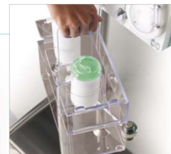
Spezielle Halterungen erleichtern das Handling der Adsorber und ermöglichen, bei wiederverwendbaren Adsorbern, eine einfache und sichere Lagerung.
