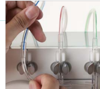
Farbkodiertes Schlauchsystem: Erleichtert die Bestückung und beugt Verwechslungen vor.
